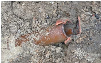
▲下水道管の劣化による破損
