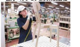
ツールの木部パーツを組み立てます。接着剤やハンマーを使って部材を取り付けたあと、紙ヤスリで磨いて製品を完成させます。
