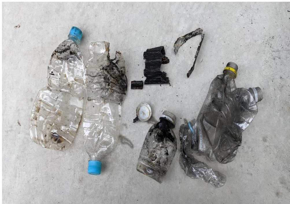
（写真中央部の黒色物が、事例2の出火原因と疑われるもの）
