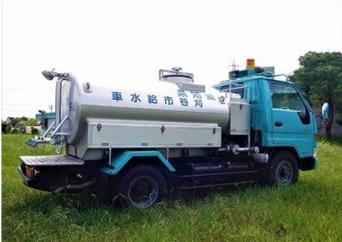
加圧ポンプ付給水車を3台（2.0 t積×2台、1.8 t積×1台）整備し、水源浄水場、一ツ木配水場、南部配水場に各一台ずつ配置するとともに、車載式給水タンクを3基（1.5 t×1基、1.0 t×2基）配備して、迅速な応急給水活動が可能となるよう備え
