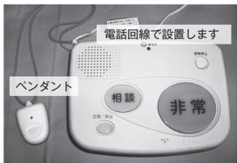
緊急時にボタン一つの簡単操作で（緊急通報システム）
