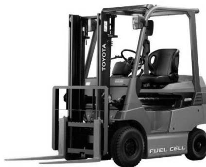
図 4.5 燃料電池自動車(左)と燃料電池フォークリフト(右)
