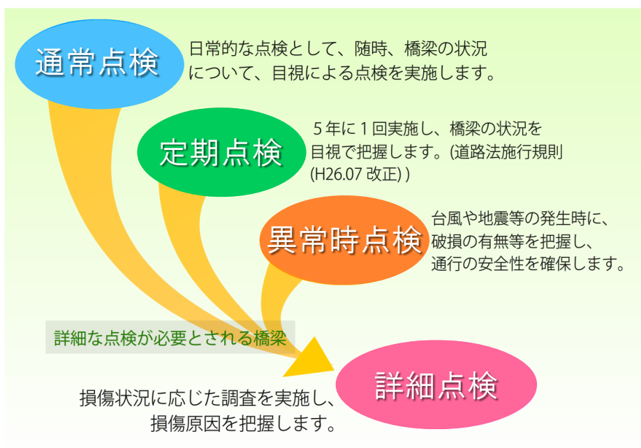
図 6 橋梁点検フロー
